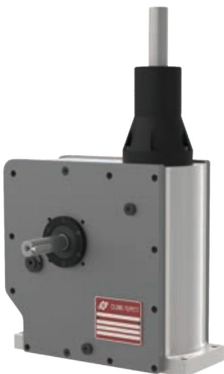
I MANIPOLATORI della famiglia MAN sono manipolatori meccanici a camma singola combinata globoidale e piana che trasformano il moto rotatorio uniforme in una opportuna serie ordinata di movimenti, lineari intermittenti e rotativi intermittenti, dell'albero di uscita sul quale vengono montati i dispositivi di presa.
