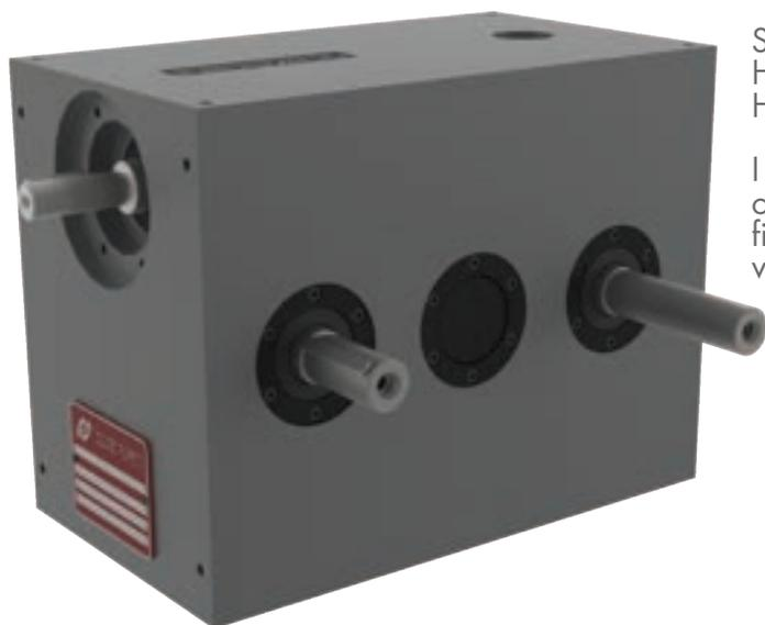
I MANIPOLATORI LINEARI della serie H..T sono meccanismi a doppia camma coniugata che trasformano il moto rotatorio uniforme in moto intermittente lineare bidimensionale, tipico dei movimenti di presa e posa.
