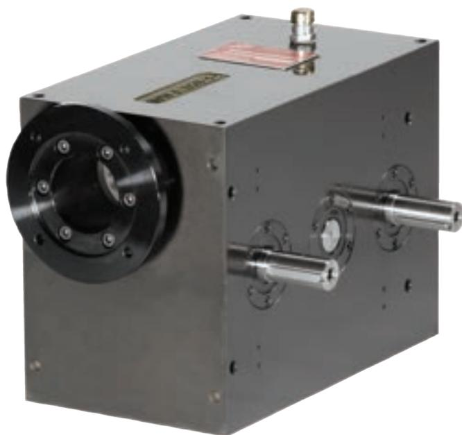
IL TANDEM CF3 è un meccanismo realizzato combinando, all'interno di una scatola, due gruppi a camme con profili coniugati e tastatori a rotella della serie CF3.
