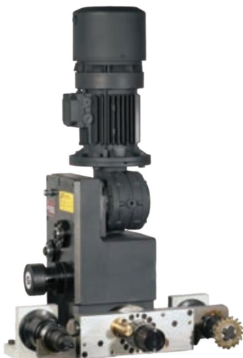
Gli HTC (Horizontal Tool Changers) sono gruppi di cambio utensile ad asse orizzontale, meccanici e completamente autonomi, che trasformano per mezzo di un meccanismo a camma il moto rotatorio uniforme in entrata, fornito da un gruppo motoriduttore, in una serie ordinata di movimenti intermittenti, lineari e rotativi, dell'albero di uscita sul quale è calettato il braccio delle pinze di presa degli utensili.
