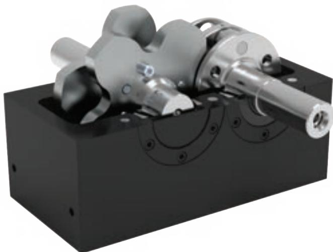
Gli INTERMITTORI e gli OSCILLATORI CF3 della serie media sono meccanismi a doppia camma piana con profili coniugati utilizzati per trasformare il moto rotatorio uniforme in ingresso in un moto intermittente unidirezionale, od oscillante in uscita.
