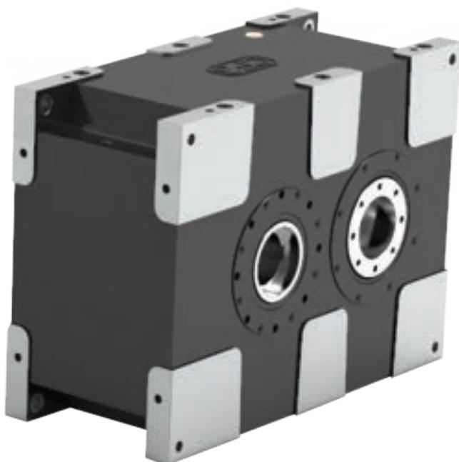
Gli INTERMITTORI e gli OSCILLATORI CF3 della serie pesante sono meccanismi a doppia camma piana con profili coniugati utilizzati per trasformare il moto rotatorio uniforme in ingresso in un moto intermittente unidirezionale, od oscillante in uscita.
