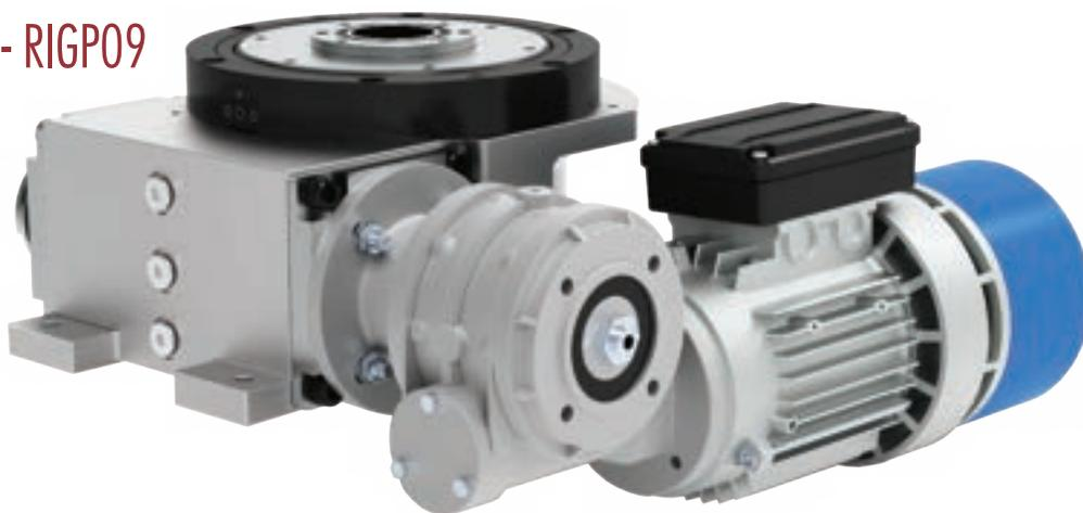
Le tavole intermittenti RIGP trasformano il moto rotatorio uniforme in ingresso in un moto intermittente in uscita. Il disco in uscita è supportato da un cuscinetto a rulli incrociati di grande dimensione che può portare carichi assiali e radiali elevati garantendo sempre un'alta rigidità e ripetibilità.
