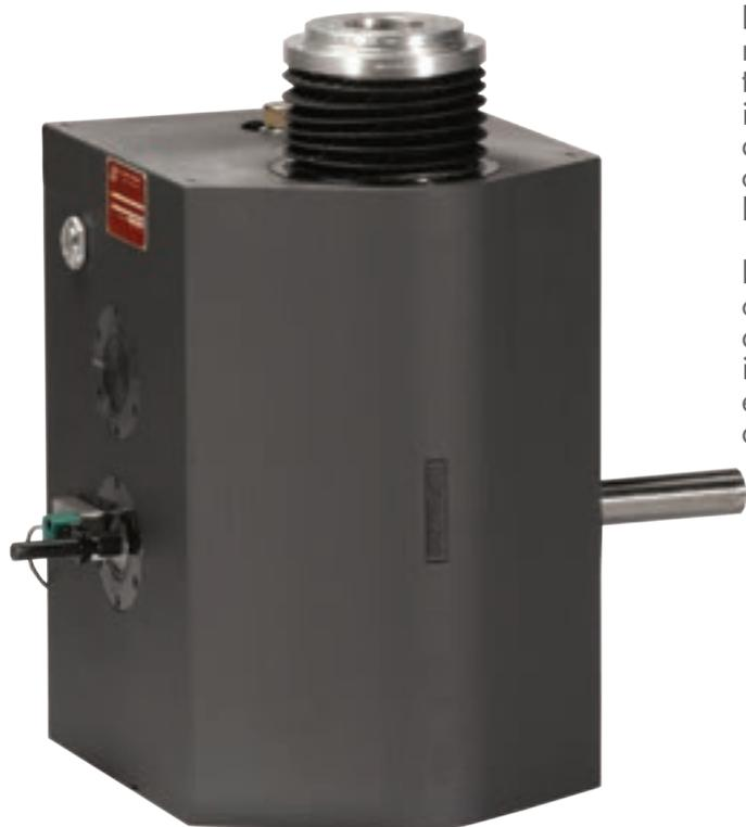
I MANIPOLATORI ROTANTI della serie H..S sono meccanismi a doppia camma coniugata che trasformano il moto rotatorio uniforme rispettivamente in: moto intermittente rotativo ed in moto lineare alternativo, tipici dei movimenti di presa e posa. Sono costruiti nelle quattro grandezze standard H65S, H80S, H105S, H130S.
