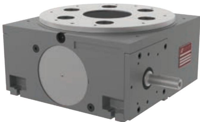
Le TAVOLE ROTANTI IR della serie pesante sono unità meccaniche a camma cilindrica che trasformano il moto rotatorio uniforme dell'albero di entrata in un moto rotatorio intermittente del disco in uscita che viene supportato da un cuscinetto a rulli incrociati.
