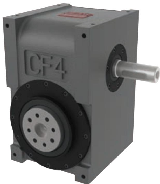
Gli INTERMITTORI e gli OSCILLATORI CF4 sono meccanismi a camma globoidale utilizzati per trasformare il moto rotatorio uniforme in ingresso in un moto intermittente od oscillante in uscita.
